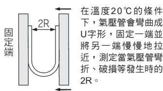
在溫度20°C的條件下，氣壓管會彎曲成U字形，固定一端並將另一端慢慢地拉近，測定當氣壓管彎折、破損等發生時的2R。
